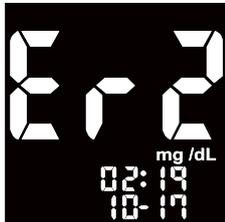
Mjerna traka testiranje je korištena ili je oštećena
